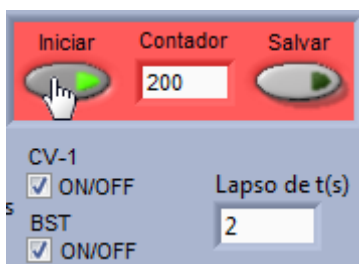
Figura 4.1 - Botão iniciar e caixas de controle para ativar CV-1 e BST
