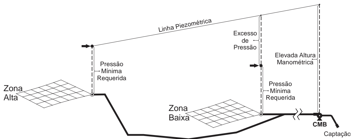
Figura 1.4 - Sistema de abastecimento de água com duas zonas de consumo
