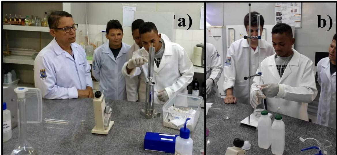
a) Determinação de teor alcoólico por ebulliometria. b) Determinação de acidez total por titulação.
