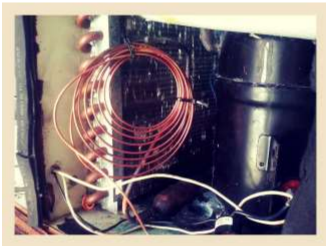
Figura C.3: Sistema de expansão capilar.
