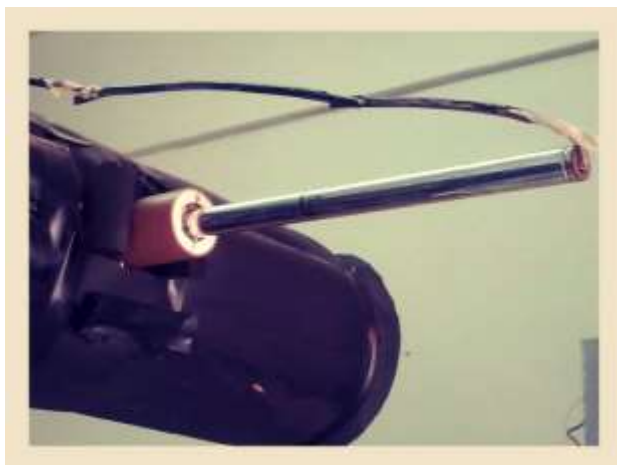
Figura 3.5: Instalação do anemômetro.
