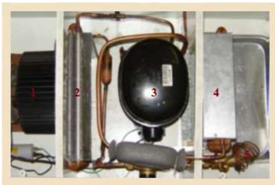
Figura 3.2. Vista superior da bomba de calor e seus componentes: ventilador (1), condensador (2), compressor (3), evaporador (4) e válvula de expansão (5).
