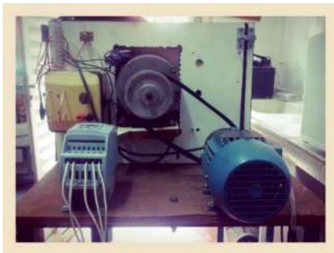
Figura 3.3: Motor externo com inversor de frequência.
