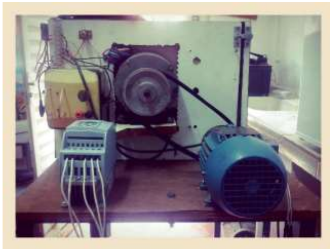
Figura C.1: Motor externo com inversor de frequência acoplado ao ventilador.
