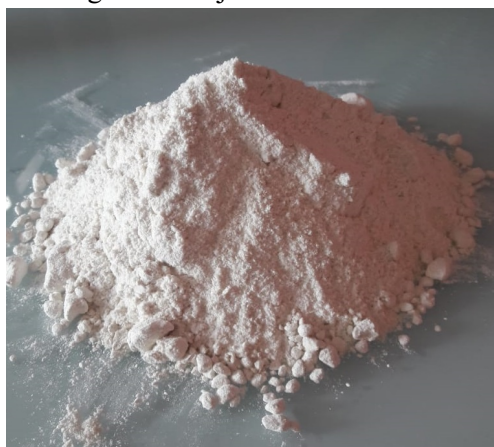
Figura 5 - Rejeito fino de caulim
