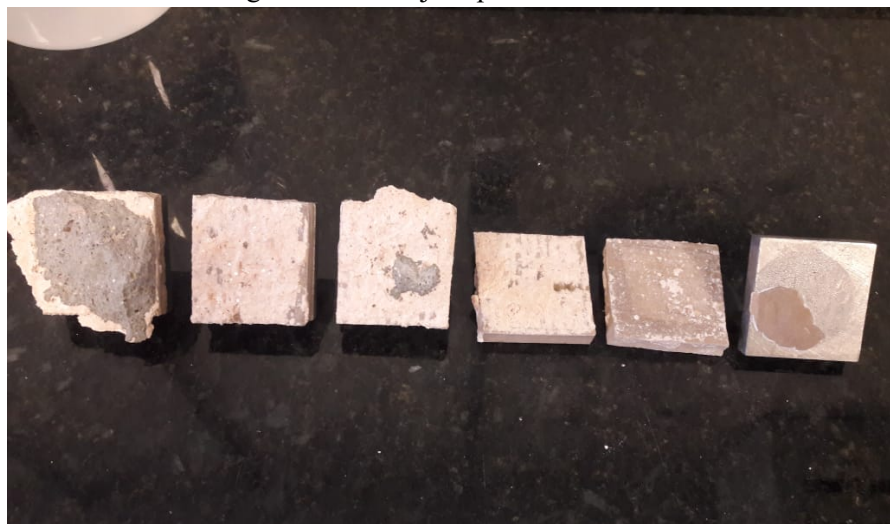
Figura 18- Azulejos após arrancamento
