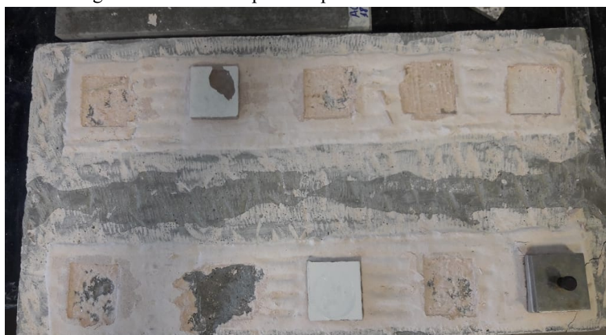
Figura 19 - Substrato padrão após ensaio de arrancamento
