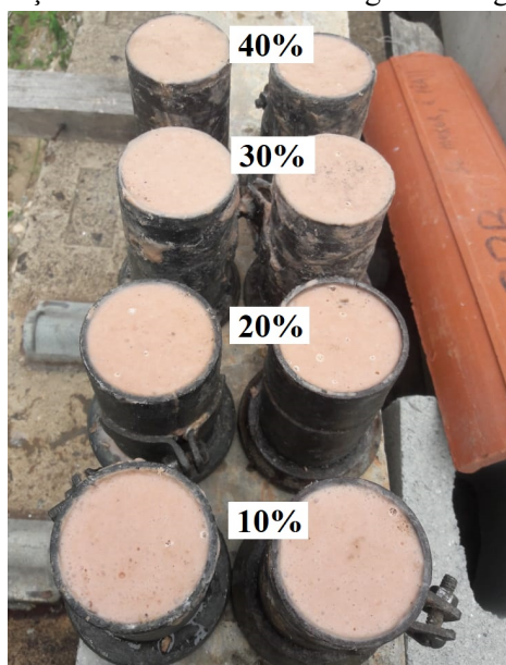
Figura 13 - Traços em estado fresco de argamassas geopoliméricas
