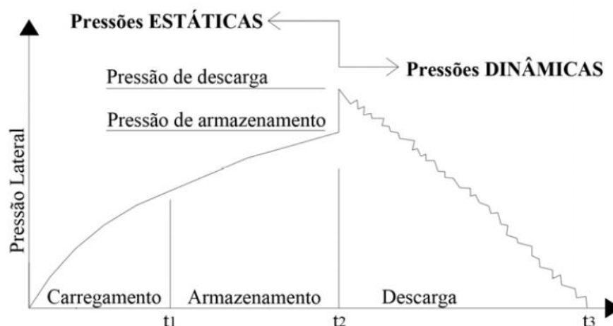
Figura 9 - Picos de pressões nas paredes do silo para um ciclo de operação de carga, armazenamento e descarga.
