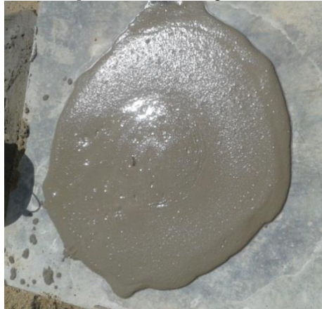
Figura 22 – Slump Flow Test em argamassa autonivelante
