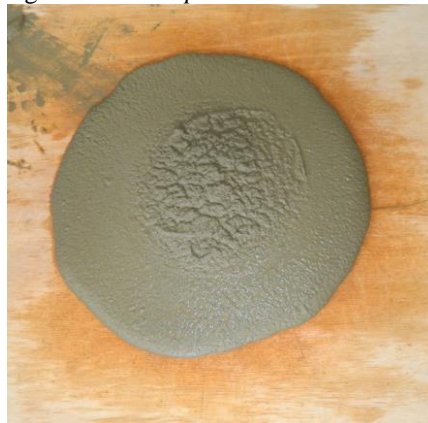
Figura 24 – Slump Flow Test do ensaio 1
