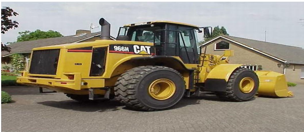
Figura 2.8: carregadeira de pneus. Fonte: CARTERPILLAR (2014).
