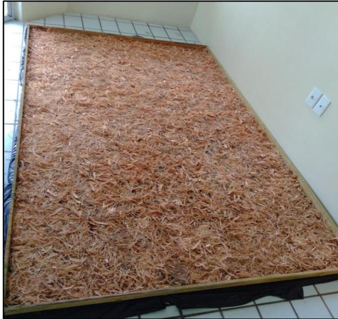
Figura 32. Distribuição das fibras sobre forma. Fonte: Autor próprio
