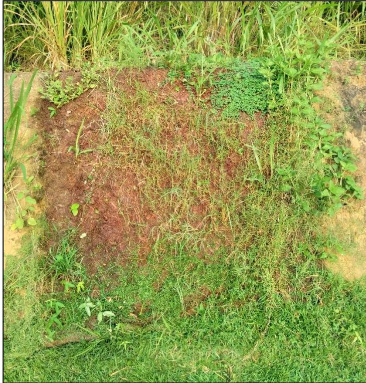
Figura 62. Desenvolvimento da vegetação sobre a biomanta 3 meses depois. Fonte: Autor próprio
