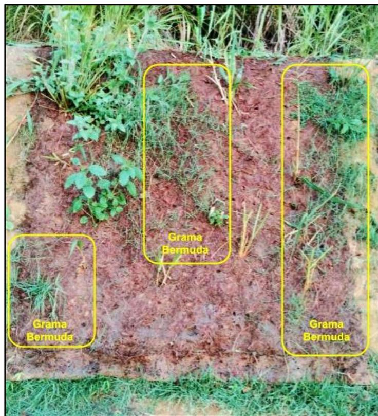
Figura 61. Desenvolvimento da vegetação sobre a biomanta 2 meses depois. Fonte: Autor próprio
