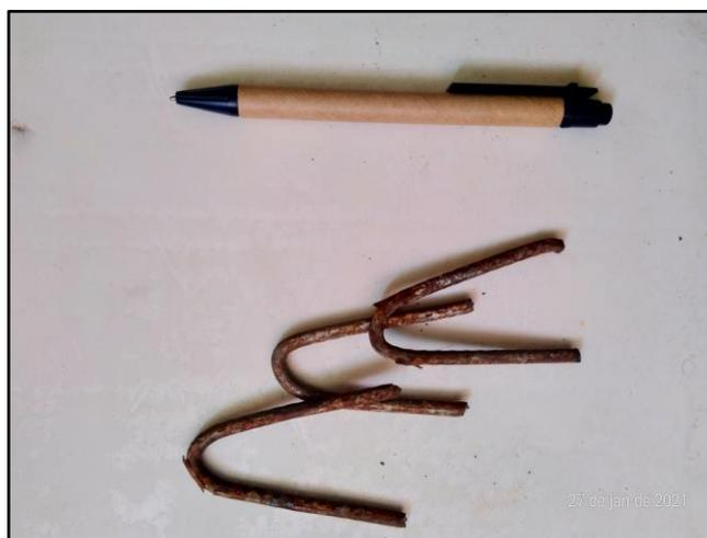
Figura 53. Grampos de aço escolhido para a fixação. Fonte: Autor próprio
