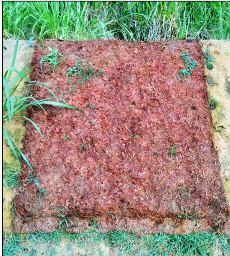
Figura 60. Desenvolvimento da vegetação sobre a biomanta 1 mês depois. Fonte: Autor próprio
