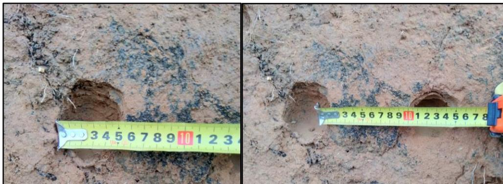
Figura 41. Dimensões das micro-covas. Fonte: Autor próprio
