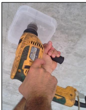
Figura 11 – Perfuração e coleta da amostra com recipiente.
