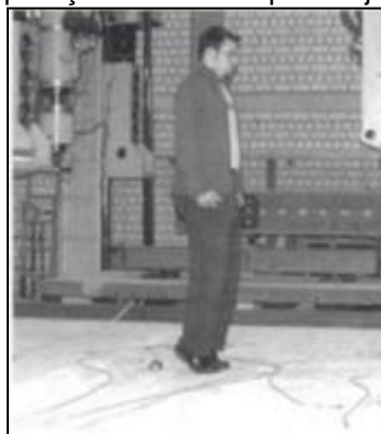
Figura 19: aplicação do heel-drop em laje de concreto
