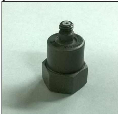
Figura 25: acelerômetro usado nos ensaios
