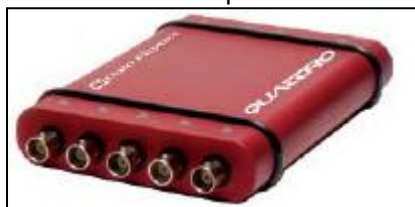
Figura 28: analisador de espectro usado nos ensaios
